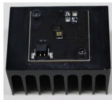
写真 5 フィン下向き (空気の流れを妨げた向き)
